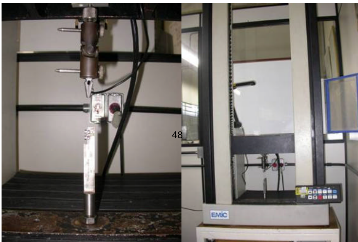
Figura 4.6: Dispositivo de teste e máquina universal de testes EMIC DL 2000
