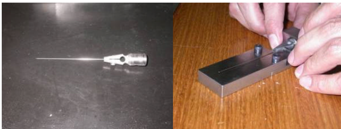
Figura 4.5: Pinça de tracionamento e ferramenta de posicionamento
