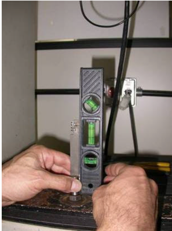
Figura 4.4 : Nível de bolha para verificação do alinhamento do dispositivo de teste
